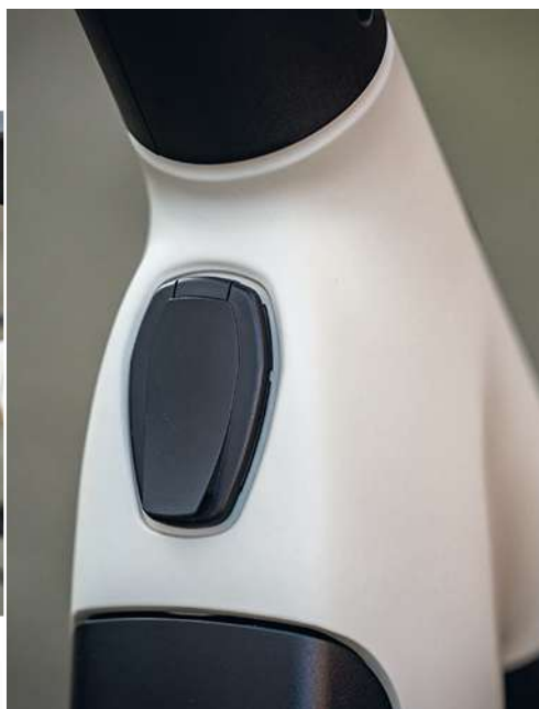
De Grenoble heeft een versnellingsnaaf met Gates-aandrijfriem (foto's links en rechts). De Bosch-accu is oplaadbaar via het frame (midden)
