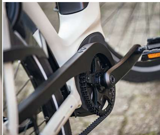
De Grenoble heeft een versnellingsnaaf met Gates-aandrijfriem (foto's links en rechts). De Bosch-accu is oplaadbaar via het frame (midden)
